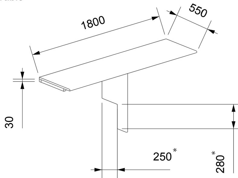
\*Découpe pour le passage de roues. Cote à confirmer selon les dimensions du véhicule, une fois l'isolation posée
