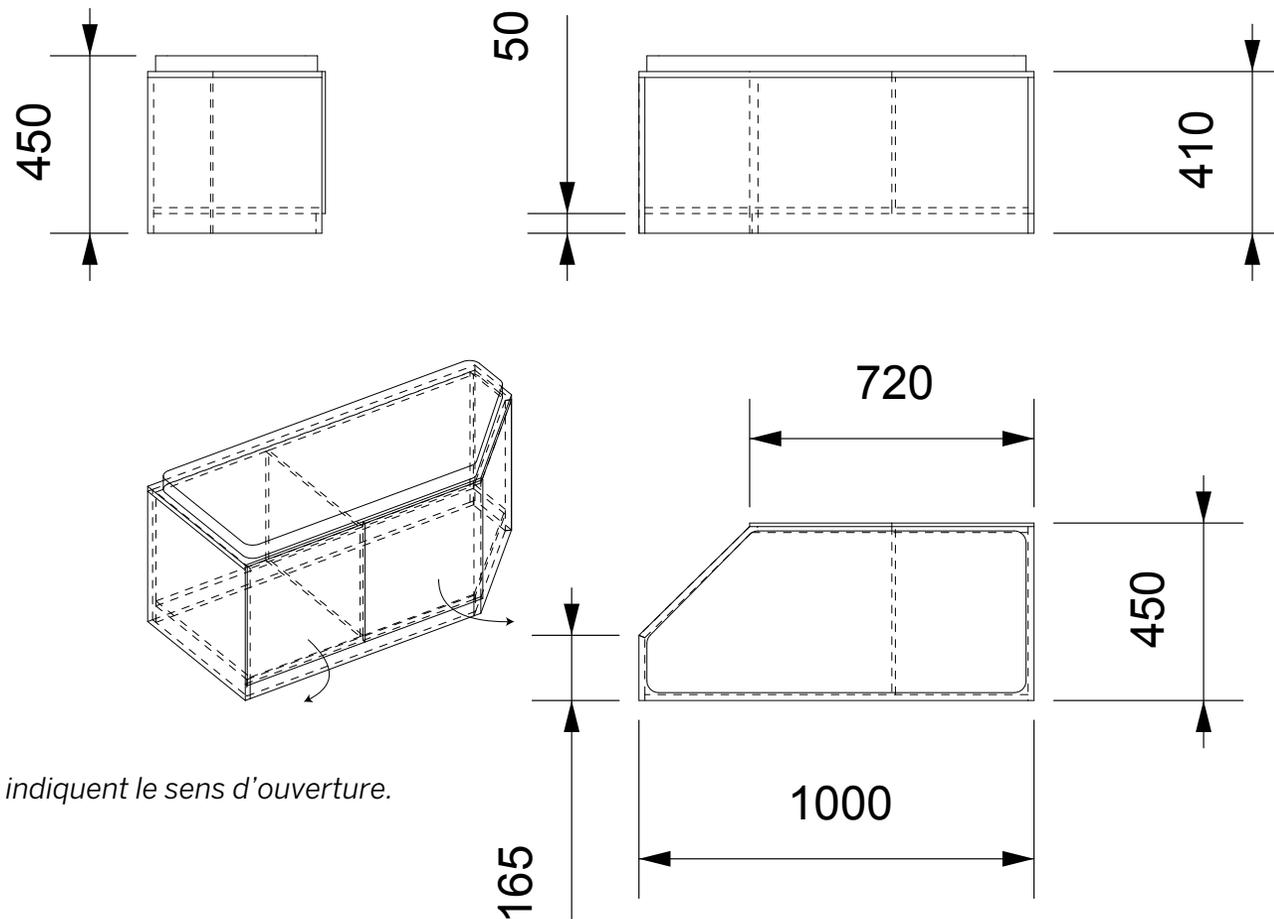
2 portes 360x360 mm. Les flèches indiquent le sens d'ouverture.
